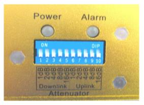
Малогабаритные DIP переключатели аттенюаторов UPLINK и DOWNLINK позволяют регулировать (в сторону уменьшения) коэффициент усиления ретранслятора раздельно в прямом и обратном направлении в диапазоне 31 дБ с шагом 1 дБ. Чтобы изменить вносимое затухание аттенюатора, необходимо перевести соответствующие рычажки переключателей в положение отличное от предыдущего (ON --затухание включено).
